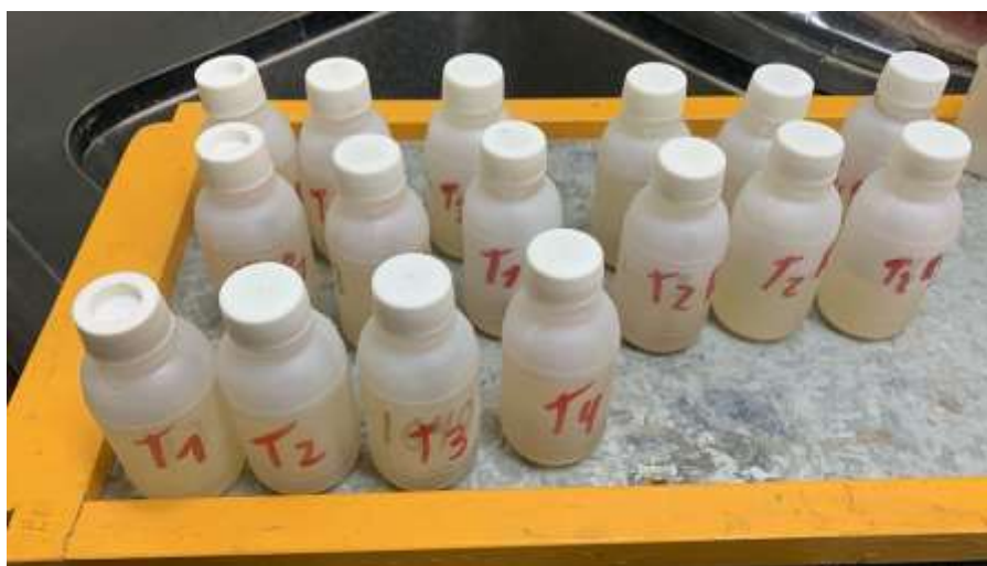
Figura 3: Extractos de saturación para analizar cationes solubles.
