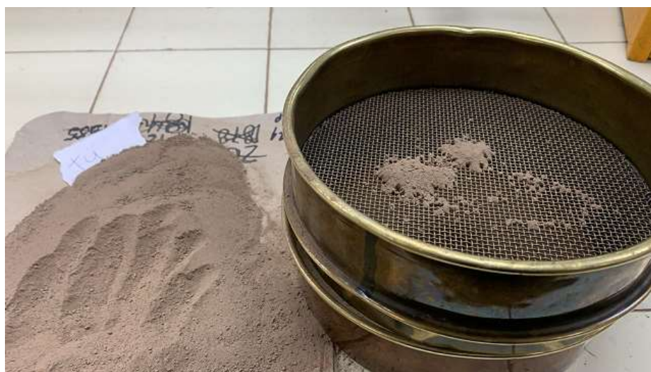
Figura 1: Acondicionamiento y tamizado del suelo.
