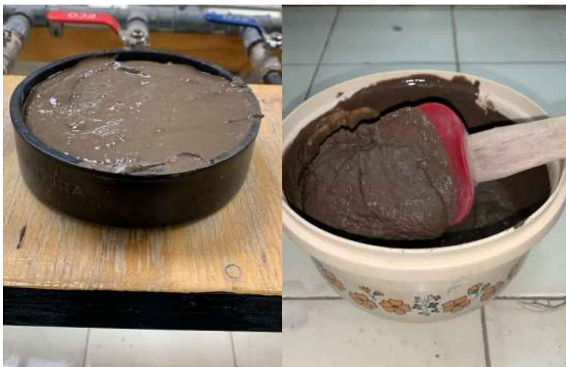
Figura 2: Preparación de pasta de saturación. Extracción del extracto de saturación mediante vacío.
