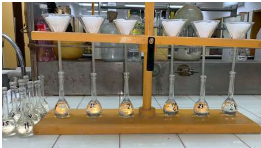
Figura 4: Extracción de los cationes intercambiables mediante solución de acetato de amonio
